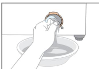
2. Coloque un recipiente debajo de la bomba. Desenrosque y retire el filtro.
